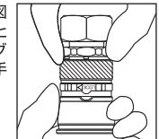
②ロックリングを矢印の方向にカチッと音がするまで(約90°)回すとロック状態になります。
