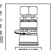
●ロックリングの凸部と本体部の凹部の位置が合うまで戻してください。
