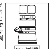
③ロックリングを矢印の逆方向にカチッと音がするまで(約90°)戻すと解除状態になります。
