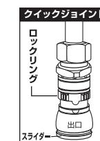
●クイックジョイントをはずすときは、を90度回しロックを解除状態にし上げてください。
